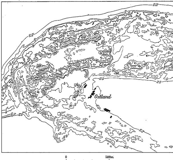
Abb. 25. Dünen auf der Insel Borkum 1:25.000, Äquidistanz 2·5 m. Schichtlinien nach der topographisch-morphologischen Kartenprobe 1:25.000, Blatt 1 „Küstendünen“. An den Schichtlinien kleine Gefällszeiger wie im Höhenliniensystem der polnischen Staatskarten 1:100.000. — Vgl. Abb. 26 und 26 a.
