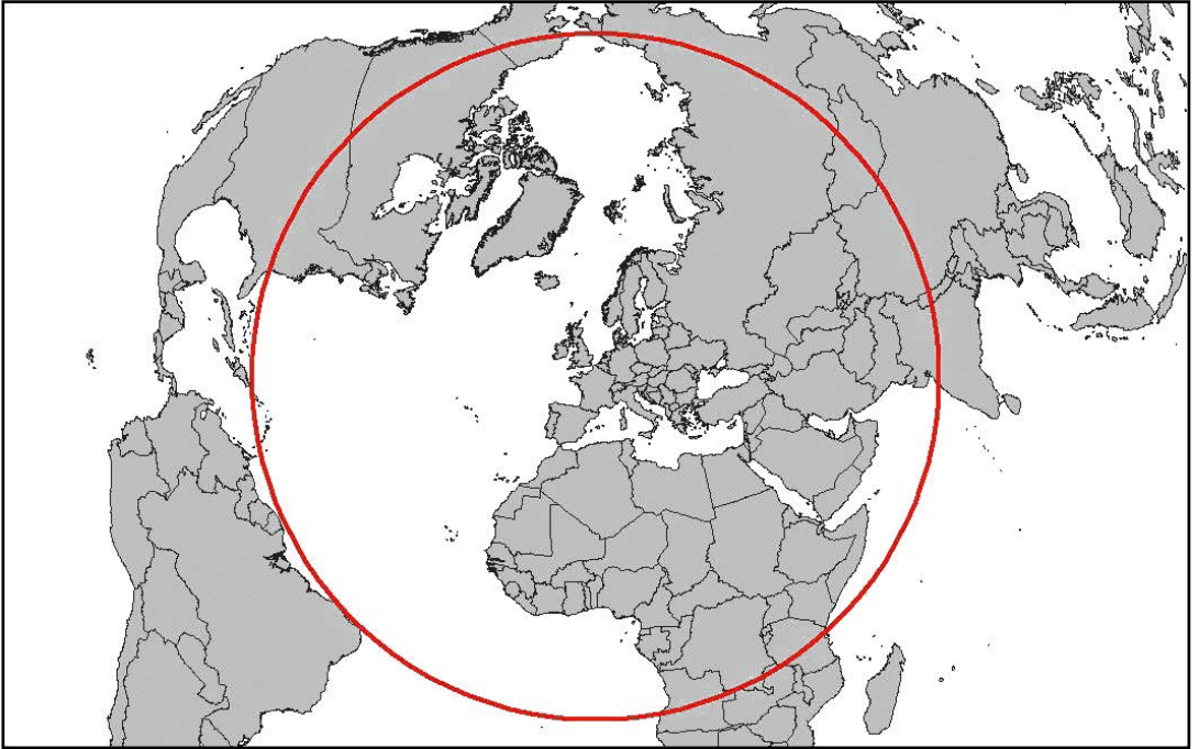
Abb. 7: Korrekter 7.000 km-Kreis um Paris in der mittabstandstreuen Azimutalprojektion
