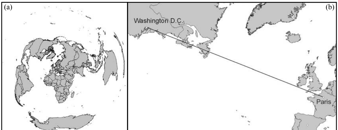
Abb. 4: Azimutalprojektion mit Berührungspunkt in Paris (a) der gesamten Erde und (b) der Strecke von Paris nach Washington
