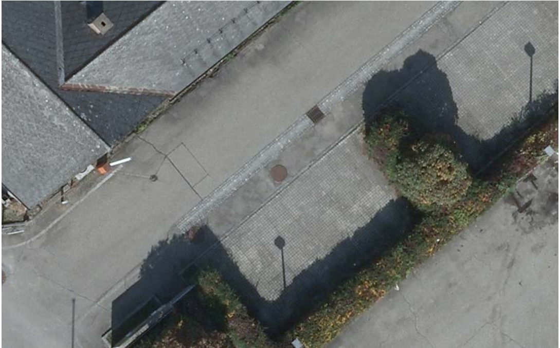
Abb. 2: Aufnahme aus einem Bildflug mit UltraCamXp über Leibnitz, Steiermark, aus einer Höhe von 500 m über Grund. Die Bodenauflösung beträgt 3 cm.
