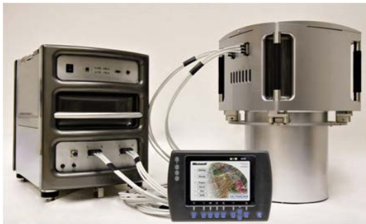
Abb. 3: UltraCamXp mit der Sensoreinheit (rechts), der Datenerfassungseinheit (links) und dem Benutzerterminal (mitte).
