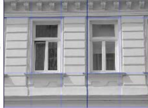
Abb. 4: Messprozedur (Aufnahme mit Hilfe der Weitwinkelkamera, Strukturierung des Objektes und Punkterfassung im Bild)
