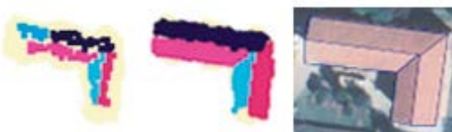
Abb. 7: Links: Aus Laserscannerdaten extrahierte Ebenen; Mitte: Verbesserung der Ebenensegmentierung durch Luftbilder; rechts: mit Luftbilddaten verbesserte Randpolygone [8].
