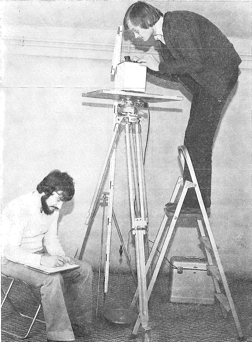
Abb. 1: Aufbau der Meßanordnung für die Bestimmung des Vertikalgradienten.
