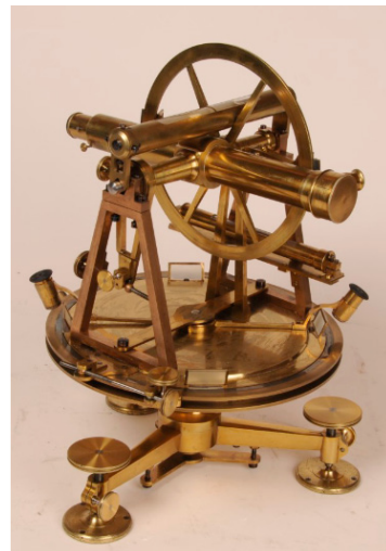
Abb. 43: 9" Theodolit Starke, 1837, von Gelpke (swisstopo Bild 5490, 2012) 31
