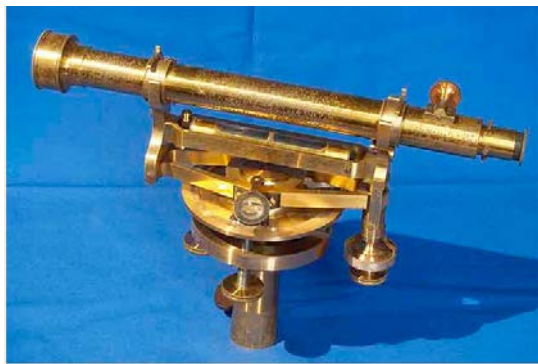
Abb. 12: Nivellier Stampfer 11 1840 (Stw. Kremsmünster)
