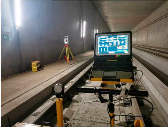
Abb. 8: Kontrolle der Gleislage der Festen Fahrbahn in der Unterflurtrasse mit einer Totalstation Leica MS60 und dem System Amberg GRP (links) und Displayanzeige während des Kontrollvorganges (rechts)
