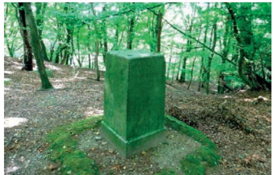
Abb. 17: Kiekeberg bei Hamburg, TP Vahrendorf 4/2525, Trig.Punkt 1.Ordn. d.Europ.Gradmessung 1868 (Foto: Reinhard Kraasch, Lizenz: CC-BY-SA 4.0 DE)
