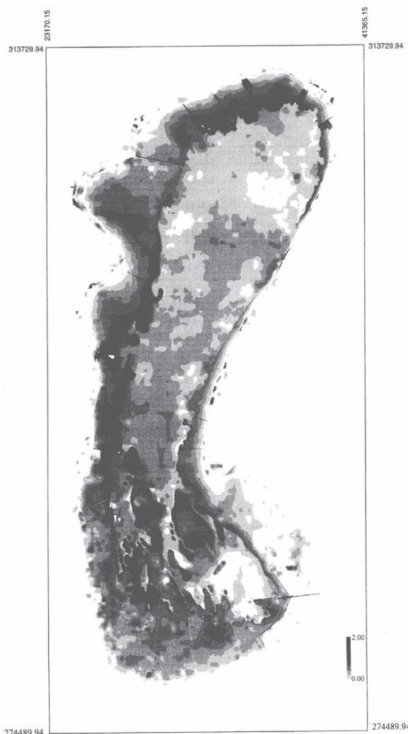
Abb. 2: Karte der Sedimentablagerungen im Seebecken in Stufen von  $\Delta h = 20$  cm, Stand 1987/95 (Csaplovics et al. 1997)
