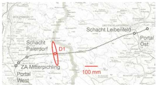
Abb. 10: Durchschlagsfehler beim KAT
