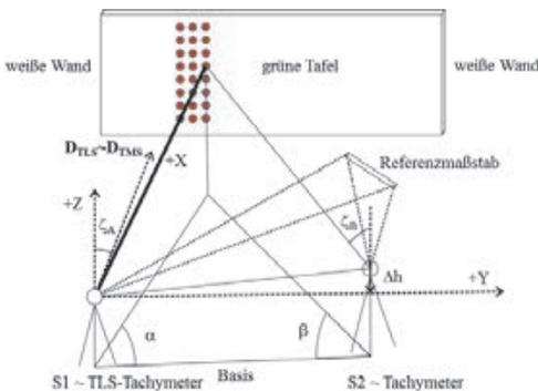
Abb. 1: Messkonfiguration
