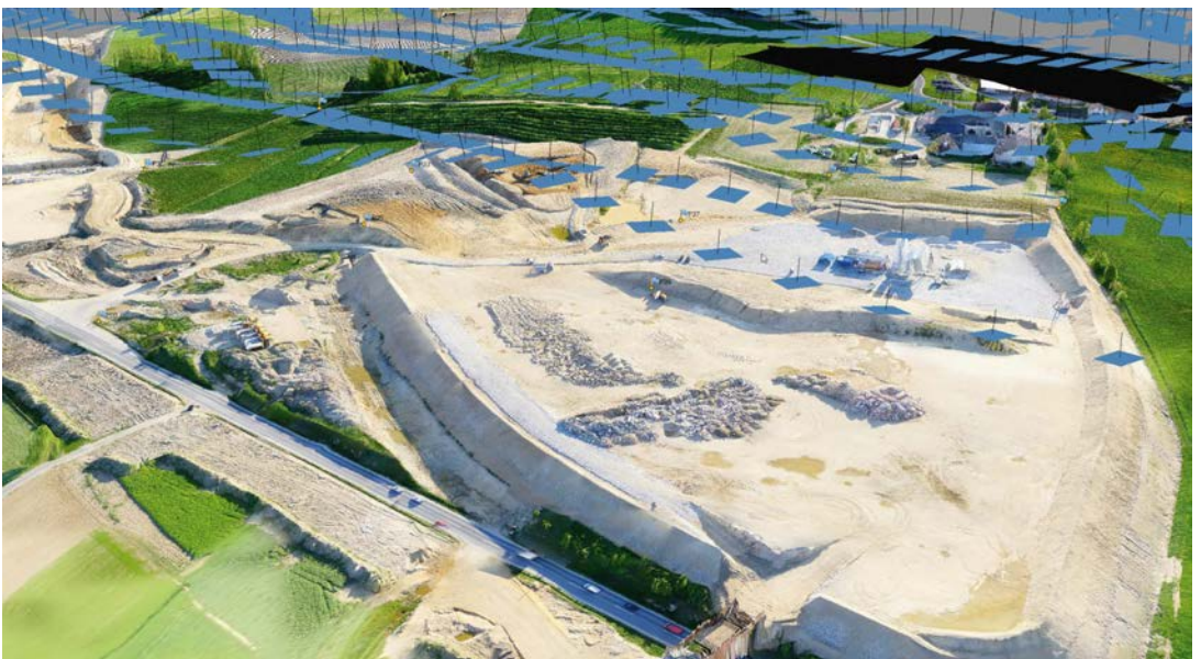
Abb. 4: Screenshot eines fotogrammetrisch erstellten 3D-Modells mit Darstellung der Kamerapositionen
