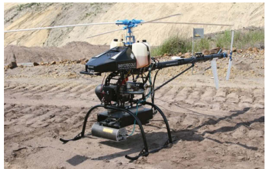
(f) Hubschrauber (Hauptrotor: 3.2 m) http://www.aeroscout.ch/
