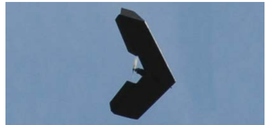
(d) Nurlügel (Spannweite: 80 cm) http://www.sensefly.com
