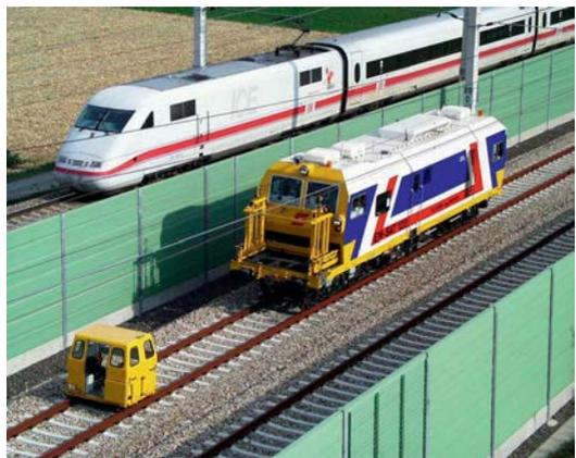
Abb. 3: EM-SAT 120; links in gelb der sogenannte Satellit
