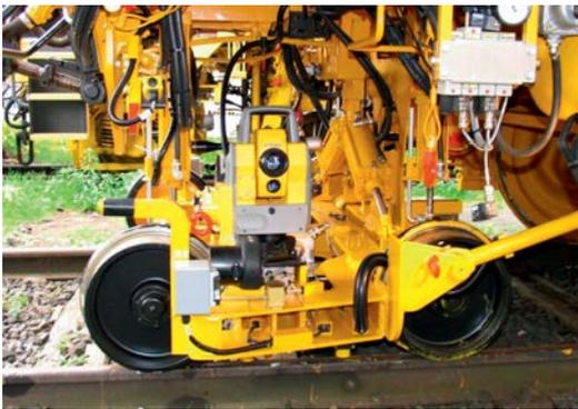
Abb. 5: Festpunktmessgerät auf EM-SAT 120
