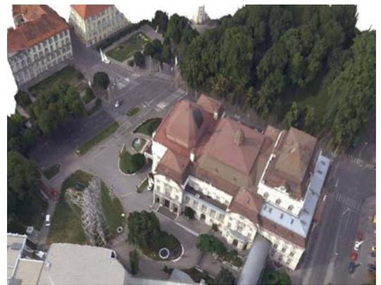
**Abb. 8:** 3000 Luftbilder von Graz aus der UltraCam digitalen Luftbildkamera. Die Triangulierung liefert eine dünne Punktwolke (25.000 Punkte pro km<sup>2</sup>) und die Kamerapositionen mit Orientierungswinkeln (oben). Unten ist das Ergebnis der Berechnung der dichten Punktwolke zu 100 Mio. Punkten pro km<sup>2</sup>, in diesem Falle mit der Phototextur überlagert (Grazer Opernhaus). Aus Leberl u.a. (2010).
