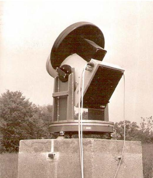
**Abb. 6:** Kamera mit Rotationsverschluss
