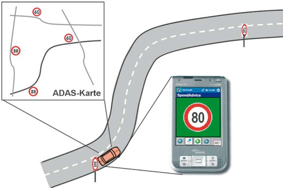
Abb. 1: Speed Alert System als Beispiel für ein kartengestütztes Fahrerassistenzsystem
