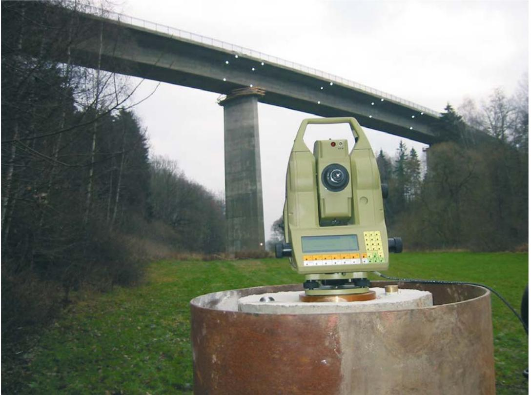
Abb. 2: Monitoring der Talbrücke Rösler
