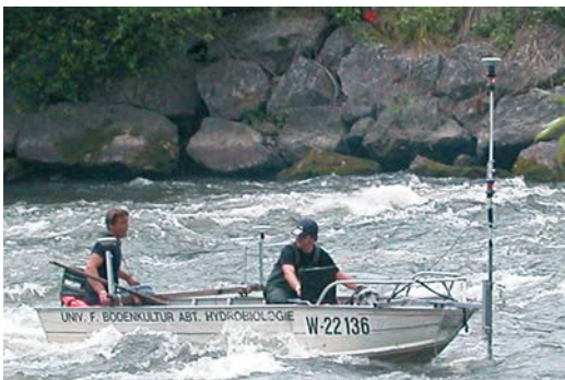
Abb. 3: Messboot mit GPS-, TPS- und Echolotsensoren
