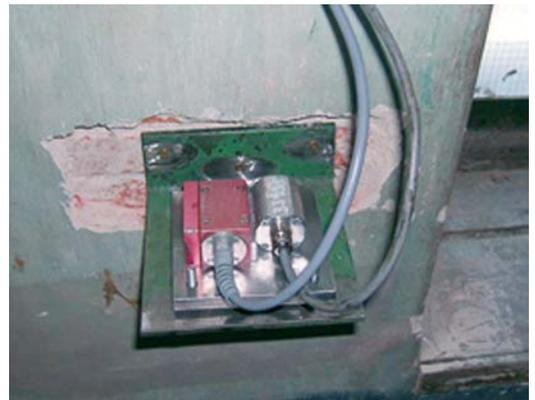
Abb. 3: Beschleunigungsaufnehmer Honeywell QA 700
