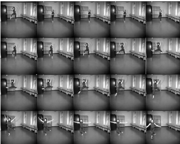
Abb. 6: Grand jeté von Abb. 5 aufgenommen mit der HCC1000 Hochgeschwindigkeitsvideokamera. Die Darstellung zeigt jeden 10. Frame der mit 462 Frames/sec aufgenommenen Sequenz.
