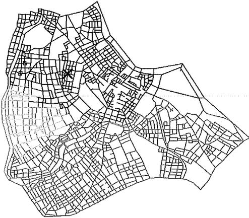
Abb. 2: Das Netzwerk-Voronoi-Diagramm von drei Generatoren auf einem Straßennetz.
