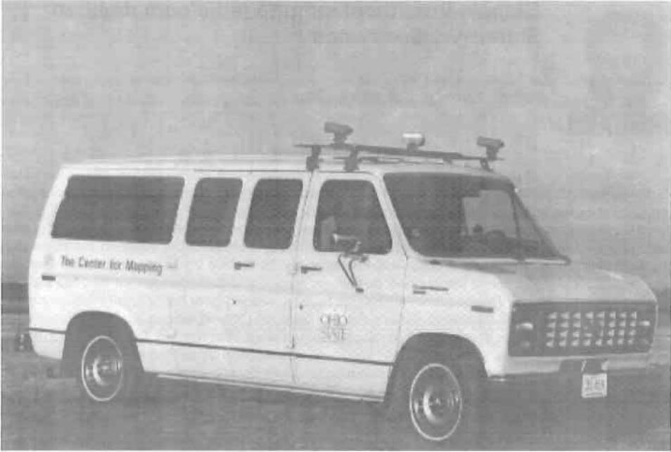
*Abb. 1: Der Vermessungsbus integriert ein digitales Stereo-Visionssystem mit GPS und einem Inertialsystem*
