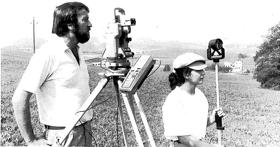
Abb. 2: Elektronischer Theodolit T 1000 mit Distanzmesser DI 1000 und Terminal GRE 3
