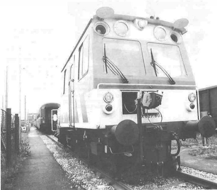
Bild 1: Das Gleis- und Lichtraum-Meßfahrzeug der ÖBB (1986)
