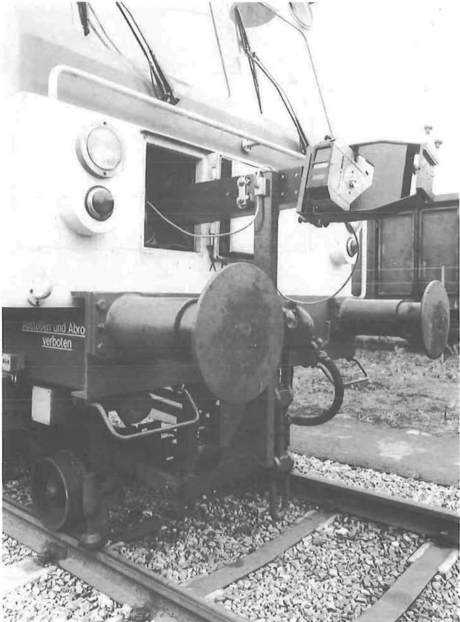
Bild 3: Das Impulslasersystem RIEGL DM 900 in Querprofil-Arbeitsstellung.
