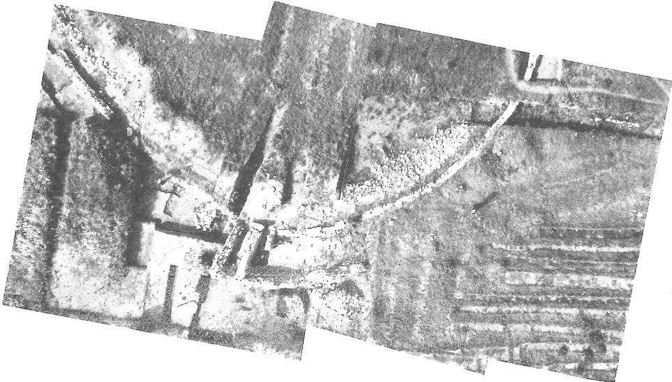
Abb. 4b: Orthophotomosaik, bestehend aus Orthophoto, hergestellt aus Ballonaufnahmen (1979) mit dem Wild OR1/SORA-OP System. Das verwendete digitale Höhenmodell (DEM) wurde in 4a erfaßt.
