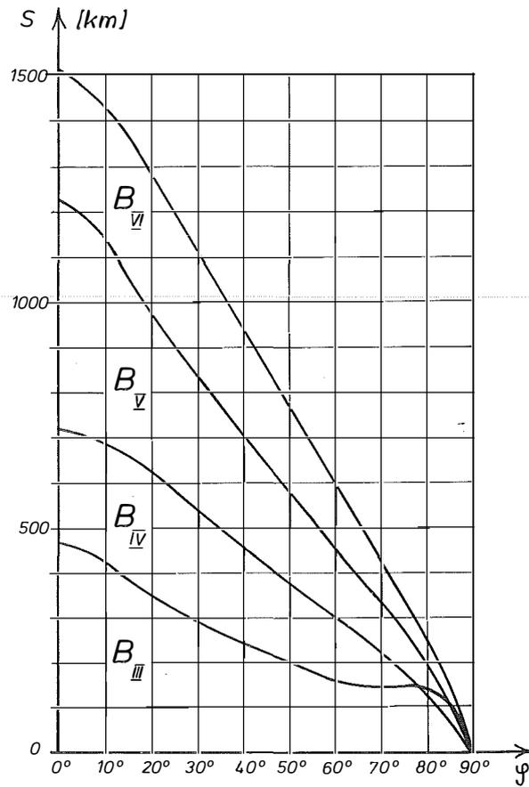
Abb. 5 Anwendungsbereich der Transformationsformeln für  $B_{III}$  bis  $B_{VI}$  bei Genauigkeitsforderungen nach (1)
