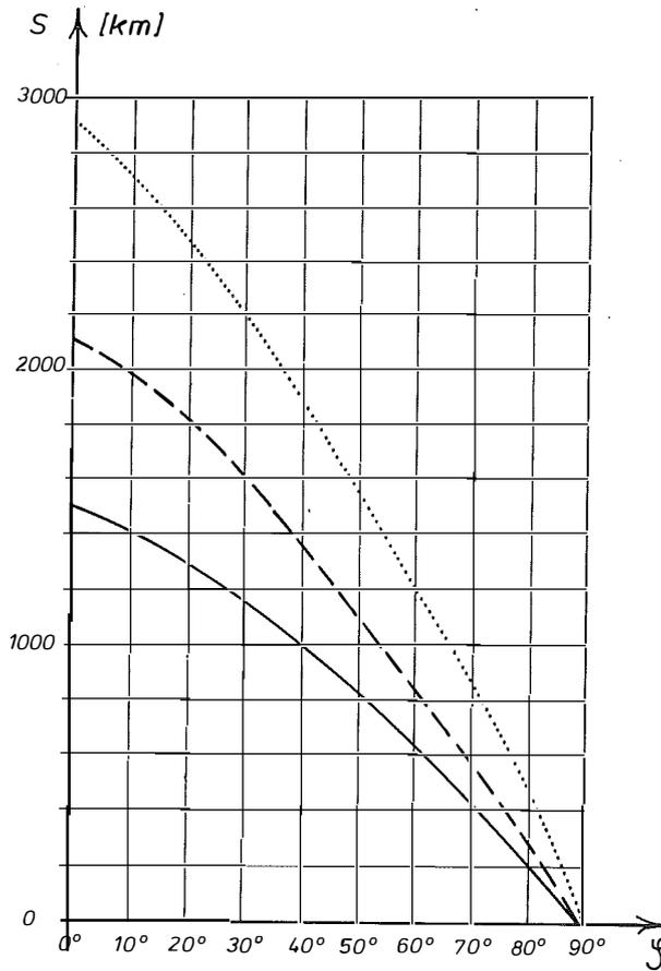
Abb. 6 Anwendungsbereich der bis zur 6. Ordnung entwickelten Transformationsformeln bei Genauigkeitsforderungen nach (1) —, nach (7) - - - - und (8) .....
