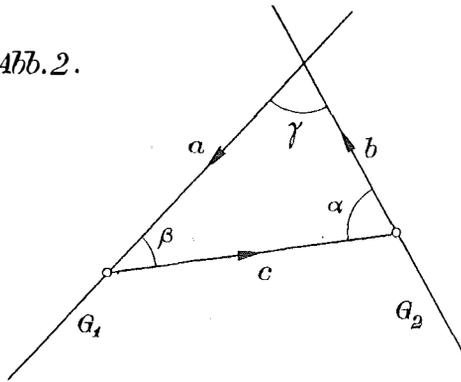
Die Gerade  $G_1$  liege im Überkreuzungspunkte höher als  $G_2$ . Der kürzeste Abstand senkt sich daher von  $G_1$  zu  $G_2$ .  $\gamma < 90^\circ$ ,  $\alpha < 90^\circ$ ,  $\beta < 90^\circ$ .
