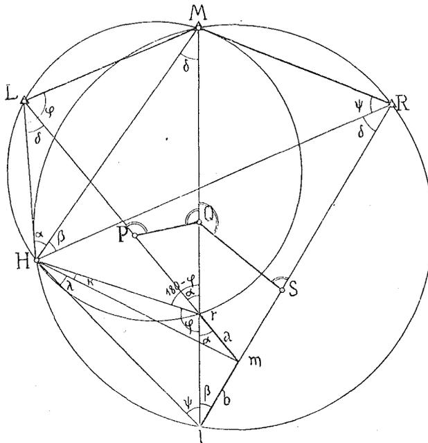
Die behandelte Aufgabe kann außer bei Punkteinschlüssen praktische Verwendung finden bei der Einordnung eines Polygonzuges in eine bestehende Aufnahme, wenn für eine anderweitige Einschaltung der Stützpunkte des Polygonzuges nicht die erforderlichen Angaben vorliegen.
