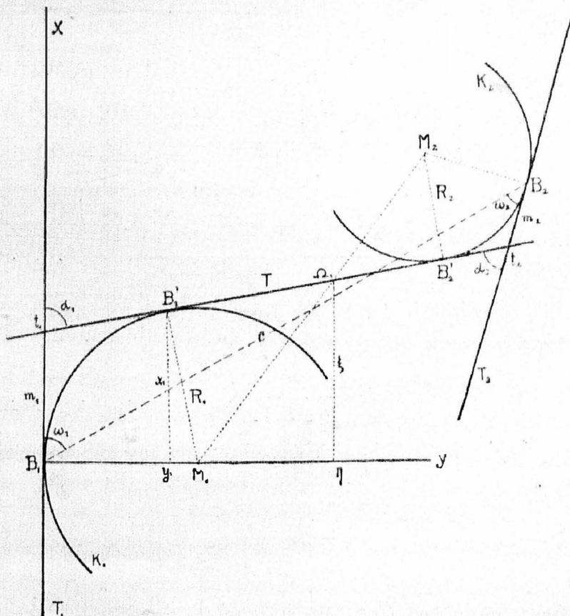
Von dem Kreisbogen  $K_1$  sei der Halbmesser  $R_1$  gegeben und die Tangente  $T_1$  mit dem Berührungspunkt  $B_1$  abgesteckt; vom Kreisbogen  $K_2$  sind die gleichen Bestimmungsstücke  $R_2$ ,  $T_2$  und  $B_2$  bekannt.
