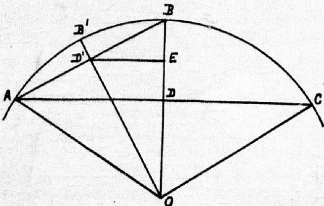
In der Tat, ist  $ABC$  der abzusteckende Kreisbogen,  $O$  sein Mittelpunkt,  $r$  sein Radius,  $\varphi = AOC$  sein Zentriwinkel, so ist die Pfeilhöhe des ganzen Bogens
