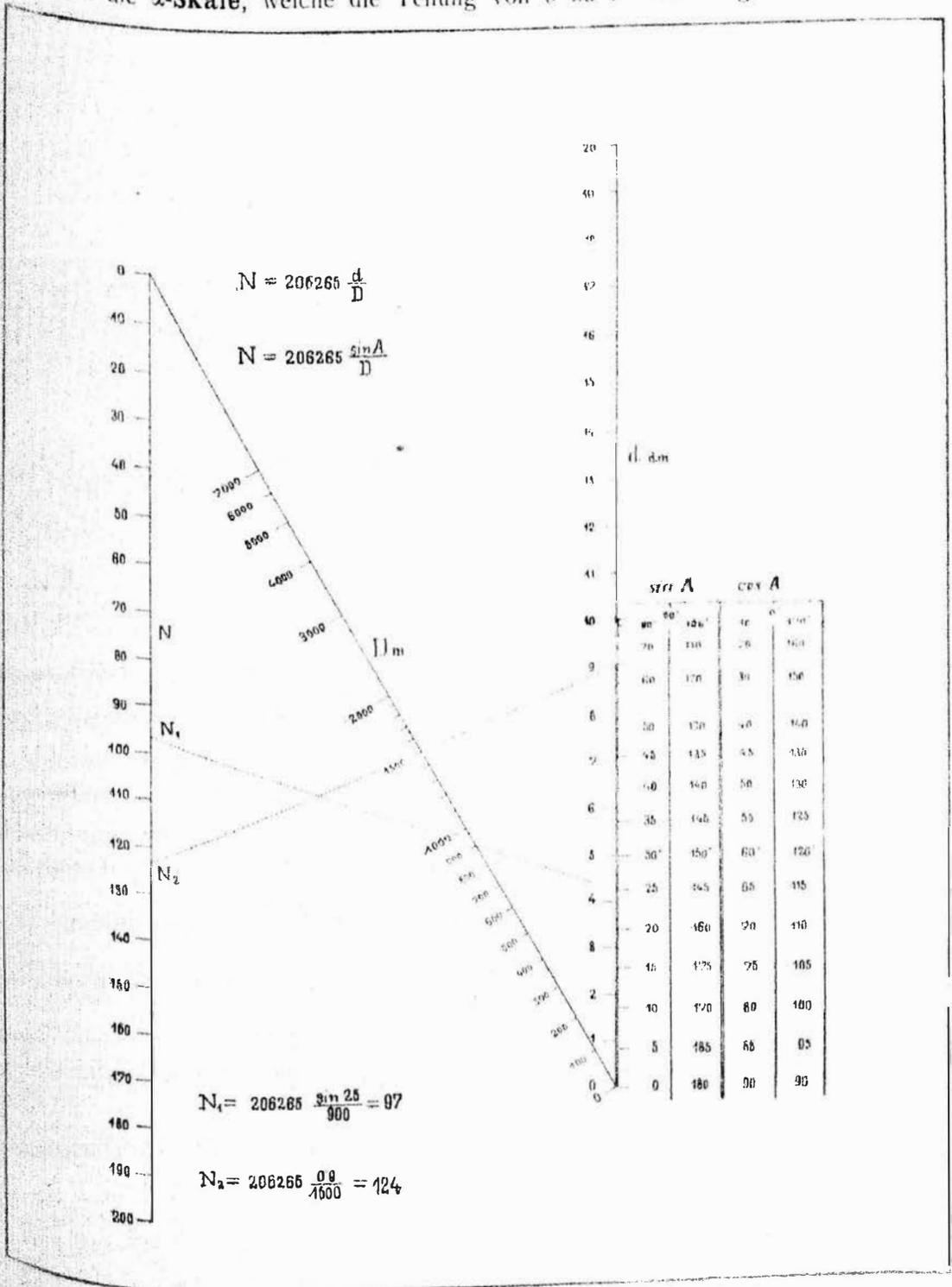
Die Querskale oder **D-Skale** trägt die nomographische Teilung von  $D$  in Metern.
