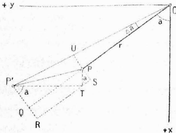
Wird der Punkt P unter Änderung seiner Koordinaten um  $PT = \Delta x$  und  $TP' = \Delta y$  nach  $P'$  verschoben, so ändert sich  $r$ , die Länge der Geraden  $OP$ , um  $\Delta r$ , und es erfährt auch  $a$ , das Azimut der Geraden  $OP$ , eine Änderung um den Betrag  $\Delta a$ , dessen Beziehung zu den Koordinatendifferenzen  $\Delta x$ ,  $\Delta y$  aus der Figur unmittelbar herausgelesen werden kann.
