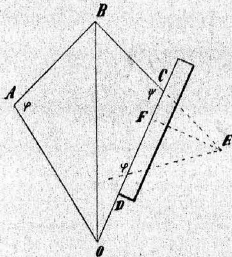
Mit einem Winkelmesser werden  $\varphi_0$  und  $\psi_0$  der Figur entnommen und  $\Delta B = 360^\circ - (\alpha + \beta + \gamma) - \varphi_0 - \psi_0$  gebildet.
