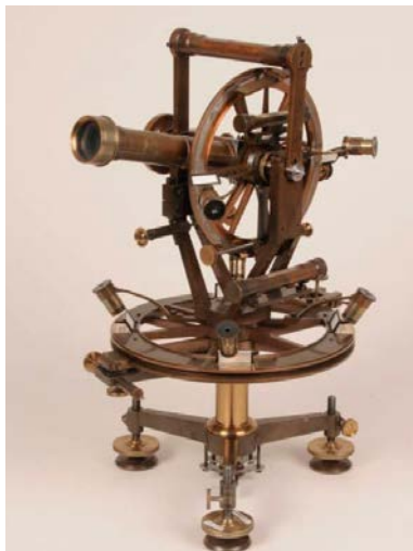
Abb. 41: 8" „Gotthard-Theodolit“ Kern, 1874, von Koppe (swisstopo Bild 9287, 2013) 28
