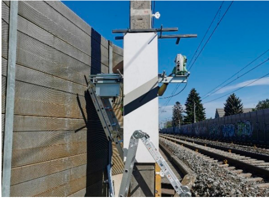
Abb. 5: Automatisierte Gleiskontrollmessungen im Bereich der A2-Querung auf der Bestandsbrücke GW14 in Kooperation mit der Fa. Geodata (links) und epochenweise Gleiskontrollmessungen an der bestehenden Südbahn (rechts)
