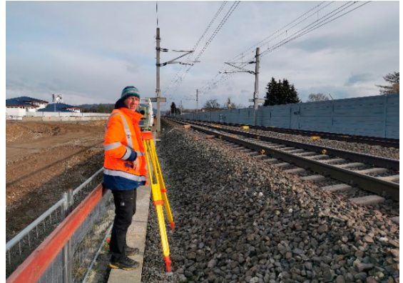
Abb. 5: Automatisierte Gleiskontrollmessungen im Bereich der A2-Querung auf der Bestandsbrücke GW14 in Kooperation mit der Fa. Geodata (links) und epochenweise Gleiskontrollmessungen an der bestehenden Südbahn (rechts)
