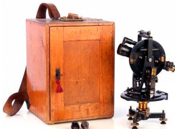
Abb. 10: Theodolit der Firma Starke & Kammerer, um 1900
