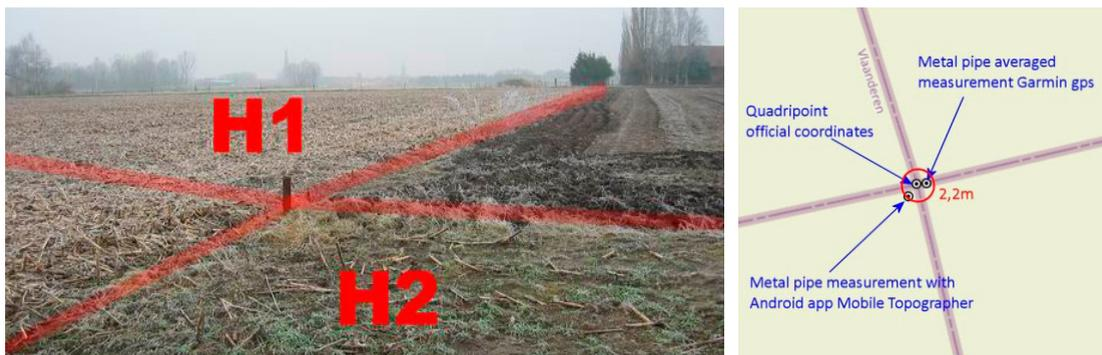
Abb. 21: Vierfachgrenzpunkt mit Metallrohr (WGS84: 51.43612 N, 4.93997 E)
