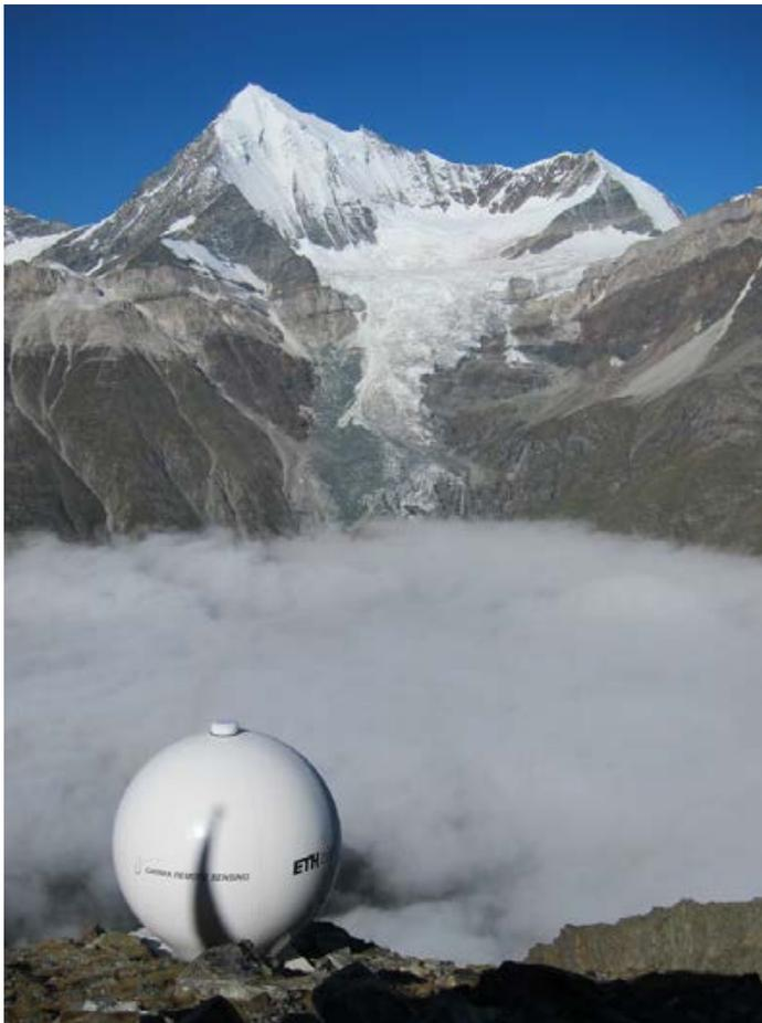
Abb. 1: Radarsystem mit Radom (Vordergrund) und überwachter Bisgletscher (Hintergrund)
