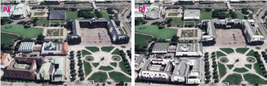
Abb. 1: (a) Laserscanning Punktwolke und Orthophoto (b) Extrudierte Gebäude mit approx. Dachflächen (Schlossplatz Stuttgart)
