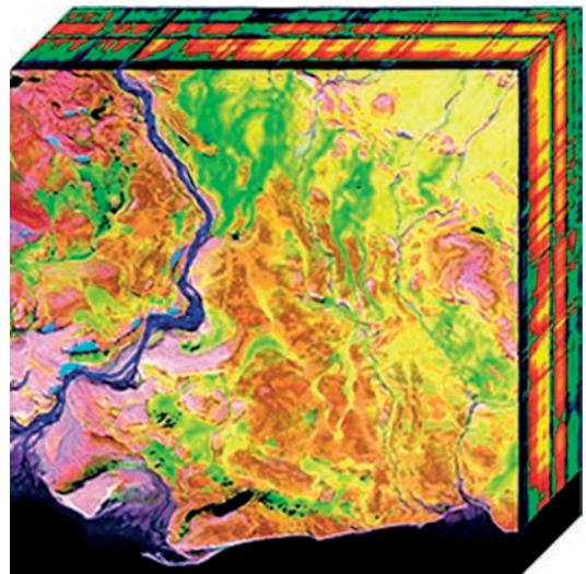
**Abb. 20:** Hyperspektrale Sensoren erzeugen Bilder in sehr vielen Spektralkanälen, welche man oft als Kubus visualisiert (Quelle [http://en.wikipedia.org/wiki/Hyperspectral\\_imaging](http://en.wikipedia.org/wiki/Hyperspectral_imaging))
