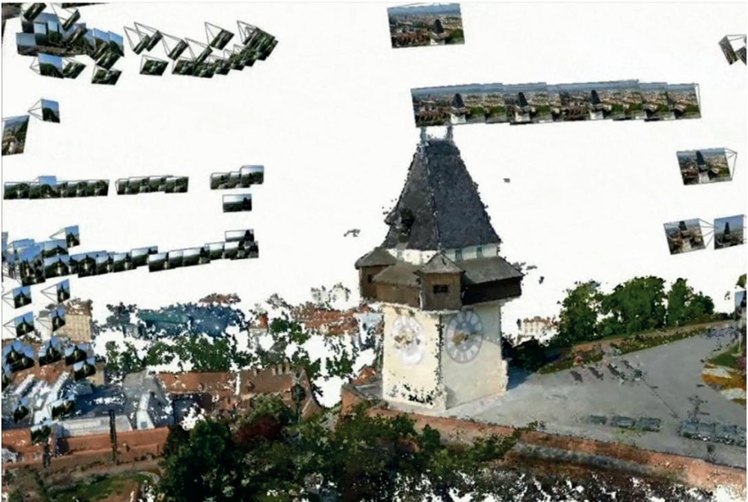
Abb. 8: Nicht standardisiert sind die Bildverbände aus neuen unkonventionellen Fahrzeugen, etwa einem MAV, wie hier vom Grazer Schlossberg [Wendel, Irschara, Bischof, 2011; siehe auch [aerial.icg.tugraz.at](http://aerial.icg.tugraz.at)].
