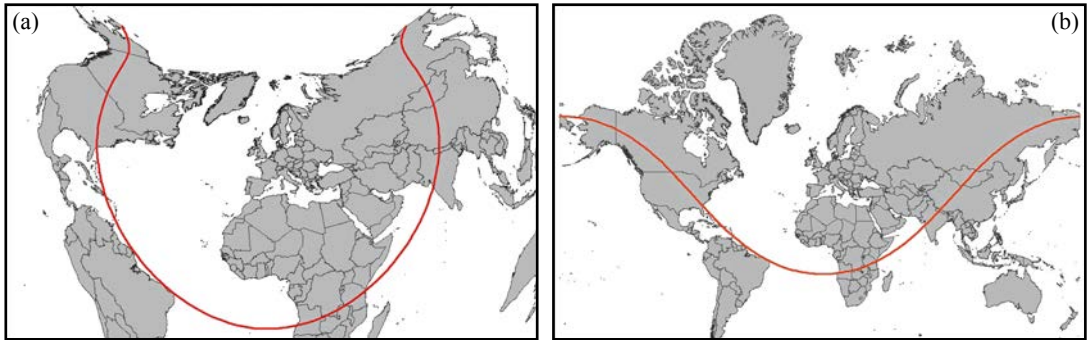
Abb. 10: Korrekte Darstellung des 7.000 km-Puffers um Paris in (a) einer Bonne-Projektion mit Mittelmeridian 30° nördlicher Breite und (b) einer Mercator-Projektion
