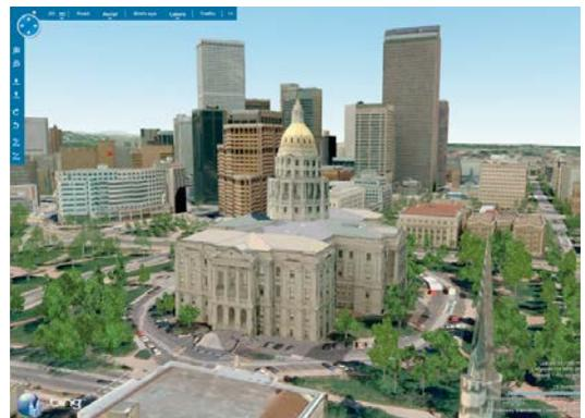
*Abb. 3: Microsofts [www.bing.com/maps](http://www.bing.com/maps) zeigt dieses Beispiel eines automatisch erstellten 3D Stadtmodells mit interpretierten Bäumen und allen Häusern. Die Hausfassaden werden aus Vertikalbildern modelliert, sind aber mittels Schrägaufnahmen texturiert. Das Gebiet ist das Capitol in Denver (USA). Dieses Detail besteht derzeit nur in US-Städten.*
