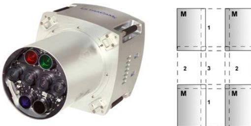
Abb. 1: UltraCamXp mit den 8 Kameraköpfen (links) und einem aus 9 CCDs und 4 Kameraköpfen zusammengesetzten panchromatischen Bild mit 17310 \* 11310 Pixel (rechts). Die Bezeichnung ‚M‘ deutet auf die 4 CCDs des sog. MasterCone hin.
