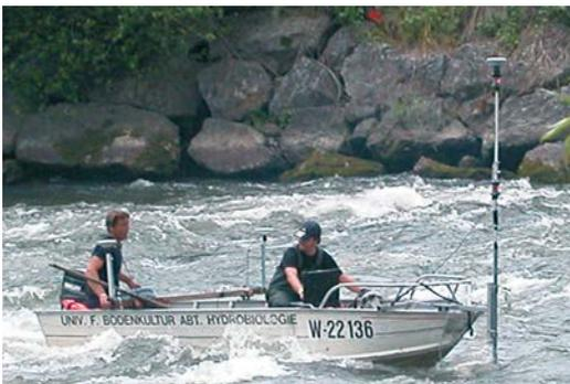
Abb. 3: Messboot mit GPS-, TPS- und Echolotsensoren
