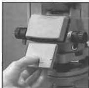
**Sicherste und komfortabelste Registrierung: REC-Modul.** Einfach in Theodolit oder Tachymeter einschieben. Leicht. Sicher. Austauschbar, mit unbegrenzter Kapazität.
