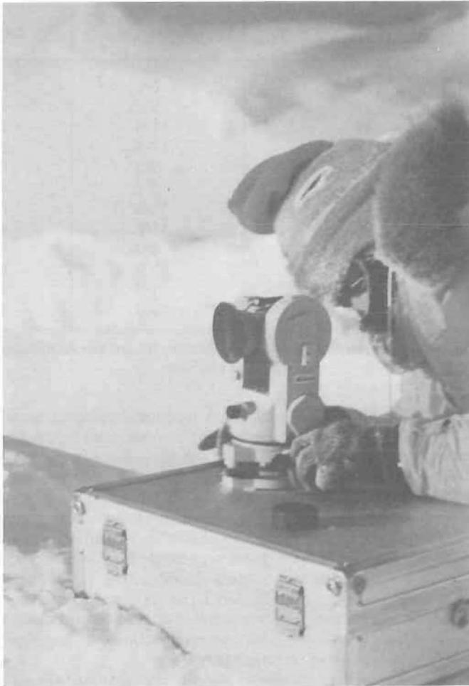
Figur 2: Bautheodolit Nikon NT-1S im Einsatz
