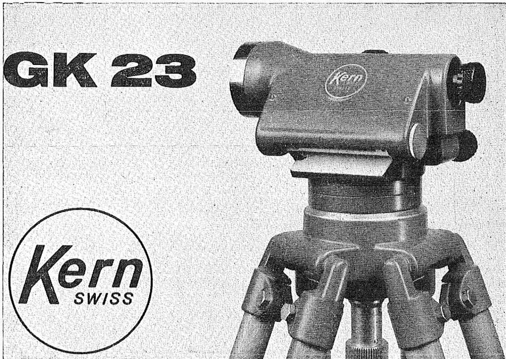
Kern GK 23, das Mehrzweck-Ingenieur-Nivellier mit den entscheidenden Vorteilen: schnellste Messbereitschaft dank dem Kern Kugelgelenkkopf, Beobachtung der Fernrohrlibelle durch das Fernrohrkular, Fokussierung mit Grob-Fein-Trieb, Seitenfeinstellschraube mit Rutschkupplung
