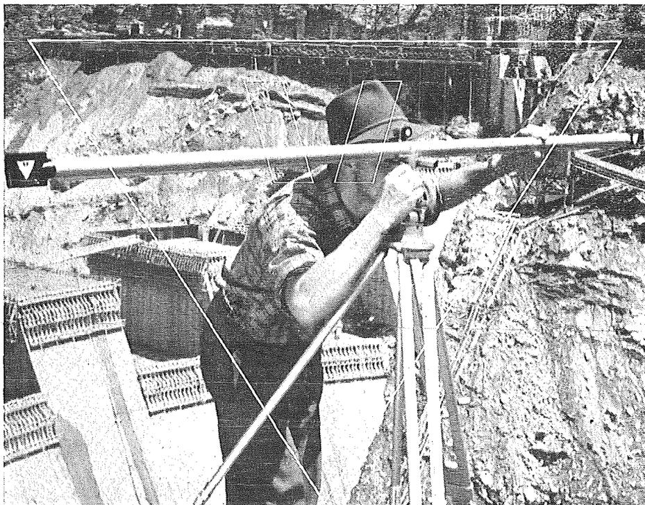
Kern-Invar-Basislatte mit 2 m Basis für vielseitigste Anwendungen bei Distanzmessungen aller Genauigkeitsstufen. Unempfindlich auf Temperatureinflüsse-leicht und doch robust. Einfachste Zwangszentrierung mit Zentrierstativ.
